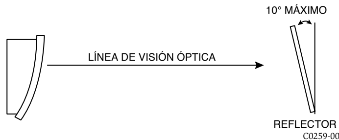
FIGURA 5B. PAUTAS DE MONTAJE DEL REFLECTOR
